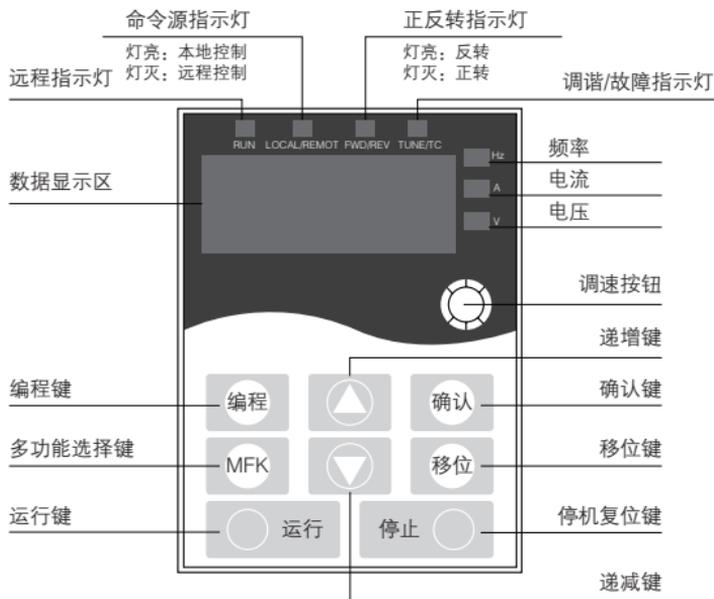
图 3-1 操作面板示意图
