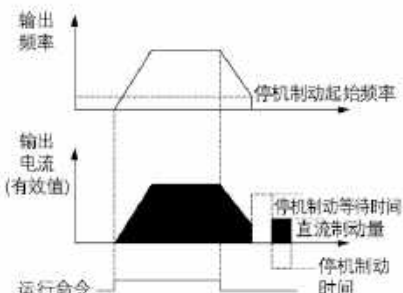
图 F1-4 停机直流制动示意图
